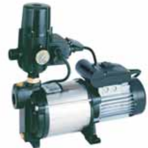
Automatska pumpa KSB-Superinox 25/4 sa zaštitom protiv suvog toka i pritiskim prekidačem 0,80kW, Q=4200 L/H; P=4,3 bar
