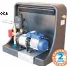
Graf KSB pumpna postaja sa automatskim ukljucivanjem između vodovoda i sistema za kišnicu sa zaštitom protiv suvog toka i pritiskim prekidačem 0,66kW, Q=3600L/H, P=3,5 bar 0,80kW, Q=4200L/H, P=4,3 bar
