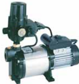
Automatska pumpa KSB-Superinox 15/4 sa zaštitom protiv suvog toka i pritiskim prekidačem 0,66kW, Q=3600 L/H; P=3,5 bar
